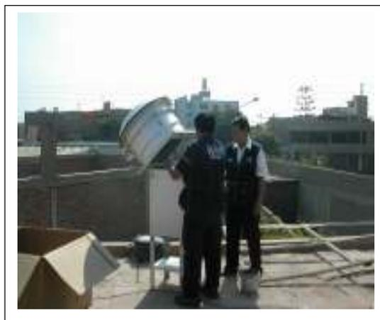
Instalación y colocación de filtro en el equipo muestreador de partículas menores a 10 Micras (PM10). Centro de Salud "La Florida"
